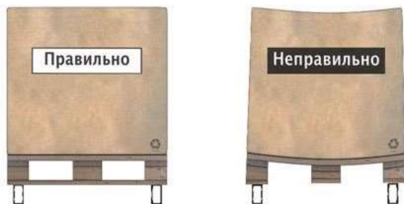
Рис. 2. Установка поддона на стеллаж
