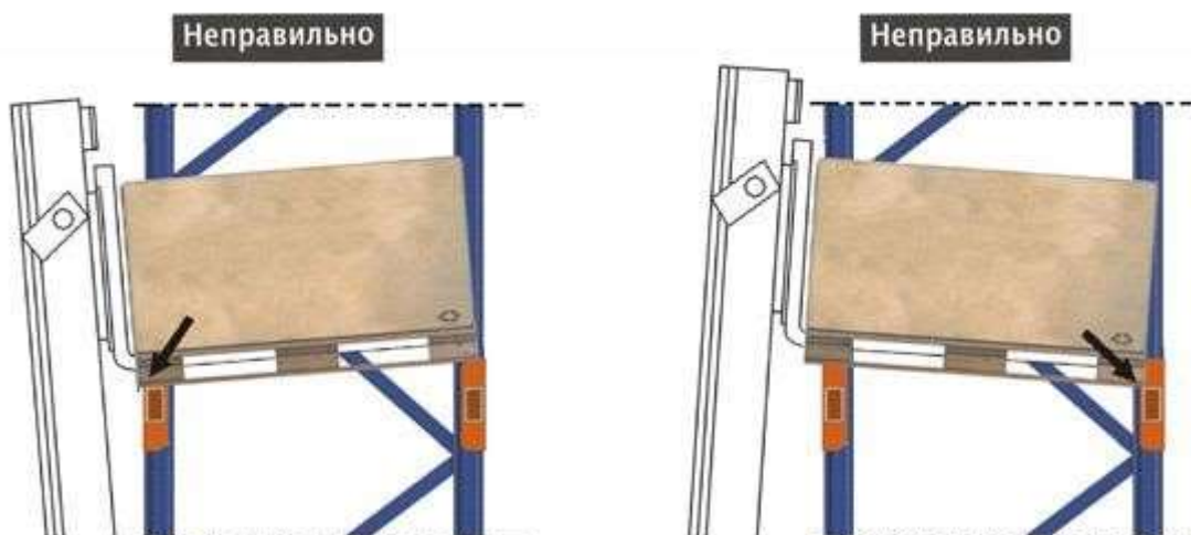
Рис. 10. Перегрузка балки в результате негоризонтальной установки груза погрузочной техникой . последствия – повреждение балок , повреждение поддона , возможное падение груза .
